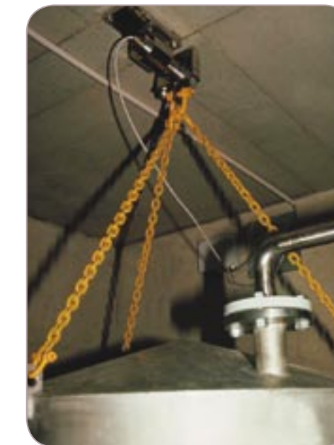
Hängende Applikation mit KIS-Kraftmessaufnehmer
